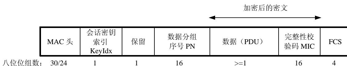
图50 WPI-SMS4 的 MPDU 封装结构
